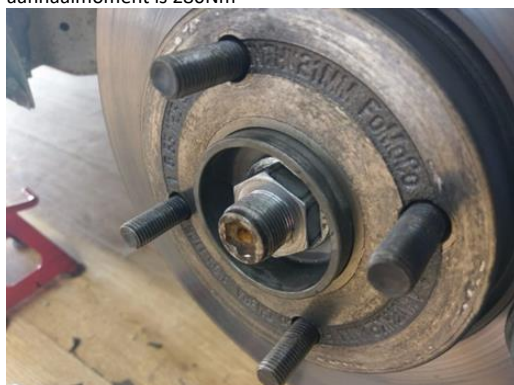
Stap 1: aangepaste moer eerst monteren, aanhaalmoment is 280Nm
