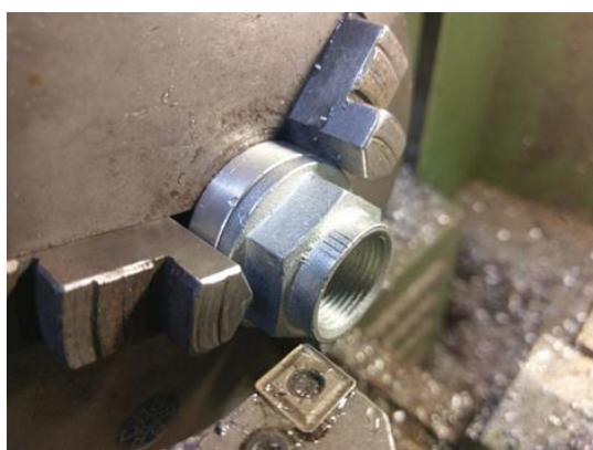
Stap 1: aangepaste moer eerst monteren, aanhaalmoment is 280Nm
