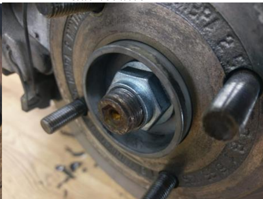
Vershil tussen de originele en aangepaste moeren: aangepaste versie moet een dikte hebben van 14mm.
